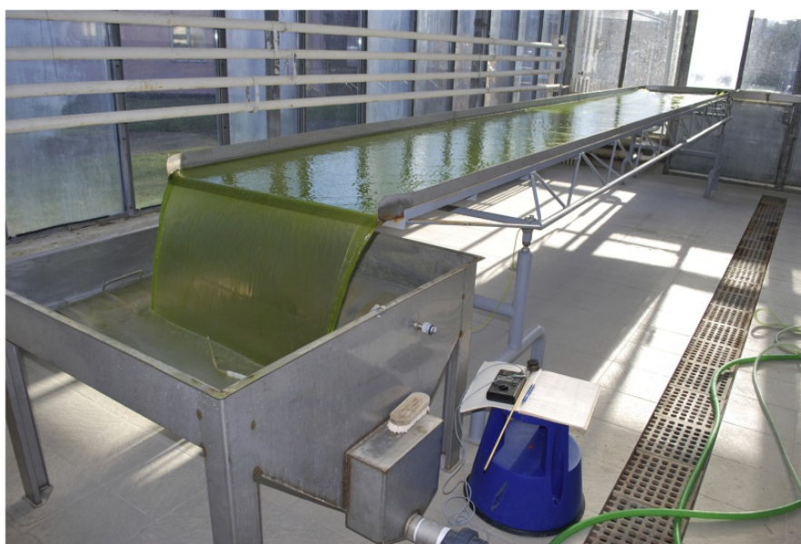
Poloprovozní kultivační pokus kmene Monoraphidium CCALA1094. Zdroj: Řezanka et al. 2017
