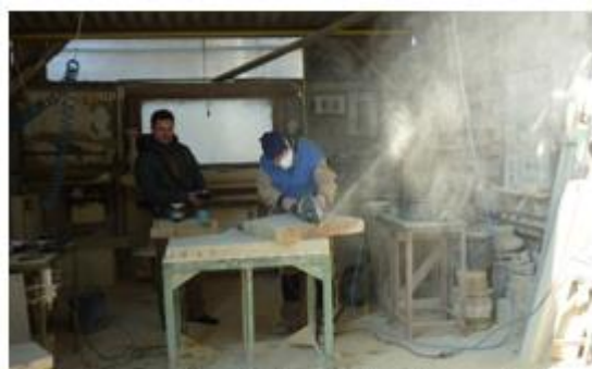
Obrázek 15 – Frézování menších dílů mimo halu
