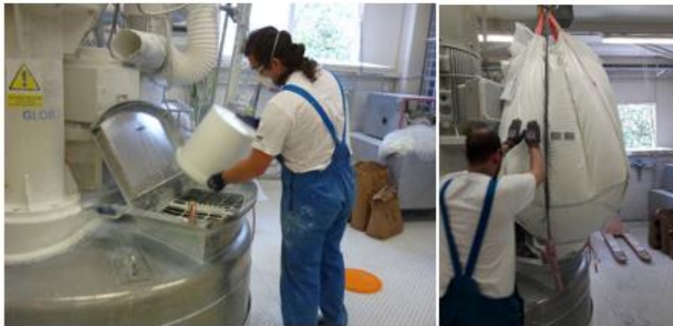
Obrázek 36 - Reaktor pro mokrou výrobu silikonové omítky
