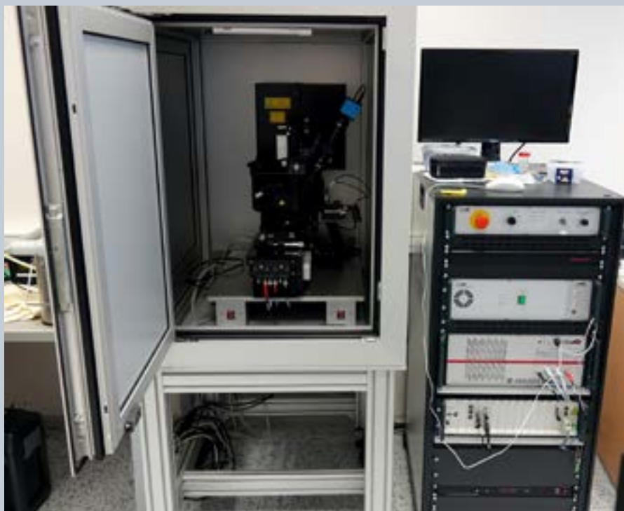
Obr. 2.4.3: Přístroj pro měření piezoelektrických a feroelektrických vlastností tenkých vrstev (TF2000)
