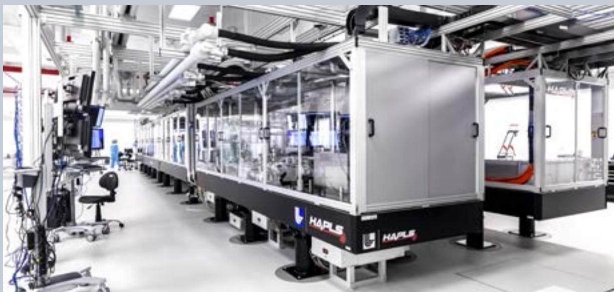
Obr. 2.6.22: Hlavní část laserového řetězce systému L3-HAPLS; v popředí je viditelná výkonová sekce čerpacího laserového subsystému
