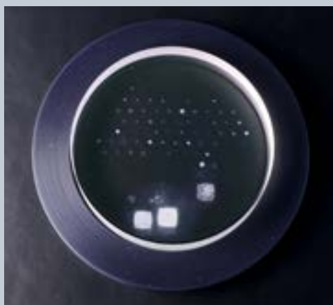
Obr. 2.5.12: (a) Vlevo nahoře – příprava vzorku na test v laboratoři LIDT, (b) vpravo nahoře – výsledný graf extrapolované hodnoty prahu poškození pro několik standardních vzorků zrcadel na vlnové délce 1030 nm a délce laserových pulzů 1 ps, (c) dole – snímek AR okna otestovaného Gaussovým zaostřeným paprskem a top-hat paprskem 3 \times 3 \text{ mm} na vlnové délce 515 nm a délce pulzů 10 ns
