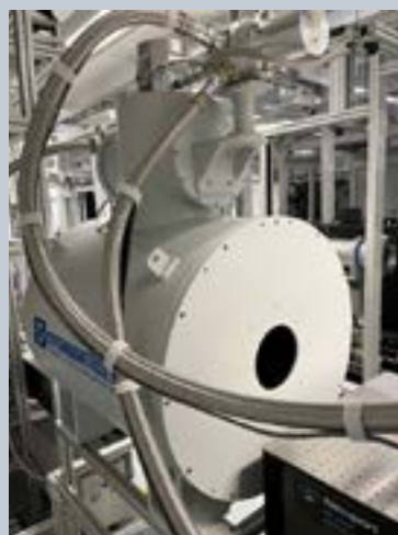
Obr. 2.5.6: Fotografie kryogenně chlazeného magnetu pro vyvíjení magneto-optický izolátor pro 100J pulzy
