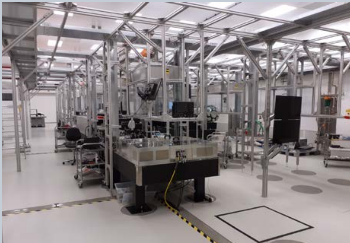
Obr. 2.6.19: Budovaný laserový systém L2-DUHA s prvním stupněm širokopásmového zesilovače v popředí
