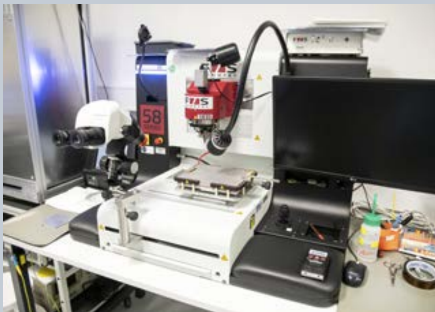
obr. 2.1.1: Automatická bondovací stanice F&S Bondtec Series 58 se standardní wedge-wedge hlavicí 5830 se využívá zejména pro bondování gama ozářených testchipů na testovací PCB, jejichž vlastnosti jsou měřeny v rámci ITk strip Quality Assurance procesů. Bondování hliníkovým drátkem o průměru 25 mikrometrů se využívá též pro měření proudové stability ITk stripových senzorů či při studiu radiační odolnosti křemíkových detektorů typu LGAD.
