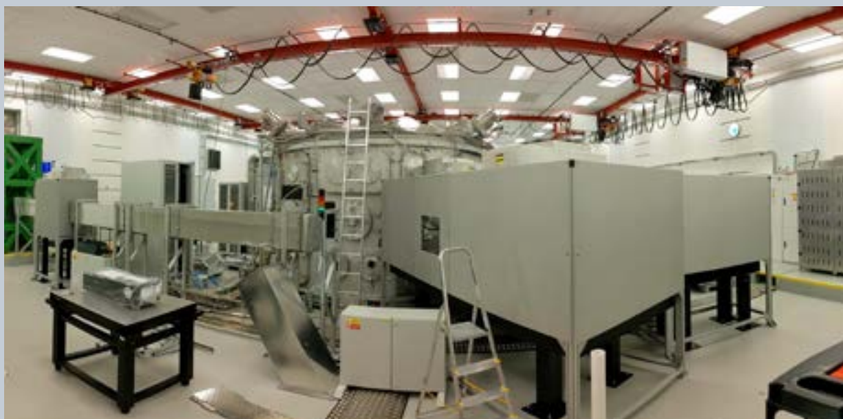
Obr. 2.6.15: Uspořádání L4n beamliny v experimentální hale E3. Vlevo: Beamlina se vstřikovacím bodem na zelené věži. Vpravo: Skříň obsahující finální optický systém pro záření L4n laseru do P3.
