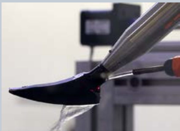
Obr. 2.5.9: Zpracování kloubního dířku technologií LSP
