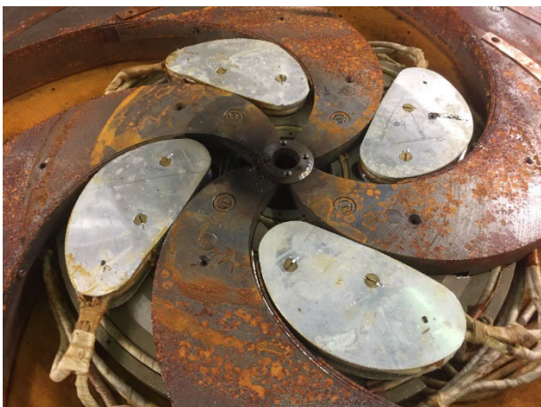
Poškozená centrální oblast.
