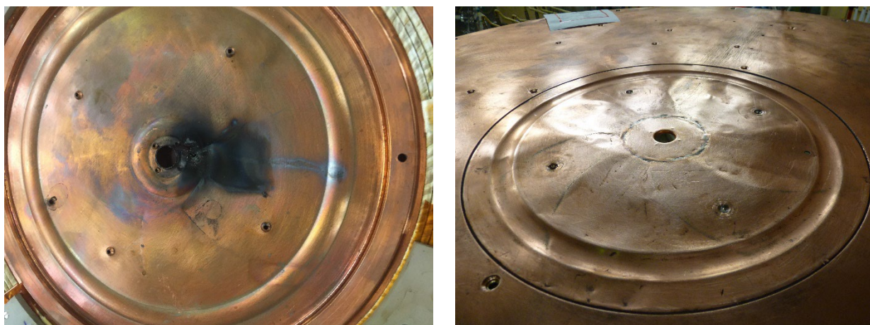
Poškozená centrální oblast před a po opravě.
