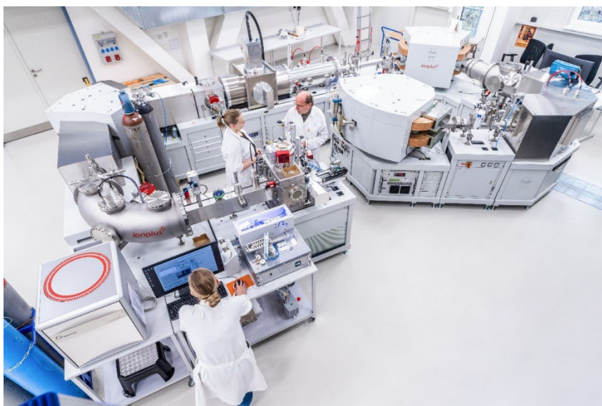
Urychlovačový hmotnostní spektrometr MILEA v laboratoři AMS (foto Jana Plavec, SSČ AV ČR).
