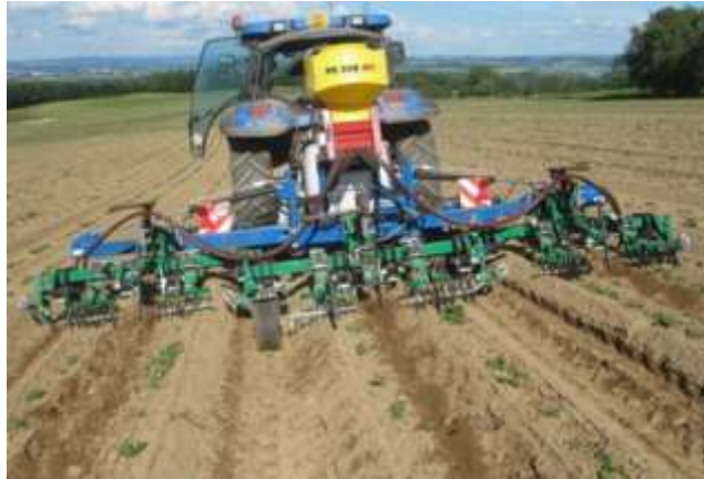
Obrázek 3 – Kypření hrůbků na začátku vzcházení brambor s obnovou důlků v brázdě, přihnojením a setím pšenice do koleje brázd.
