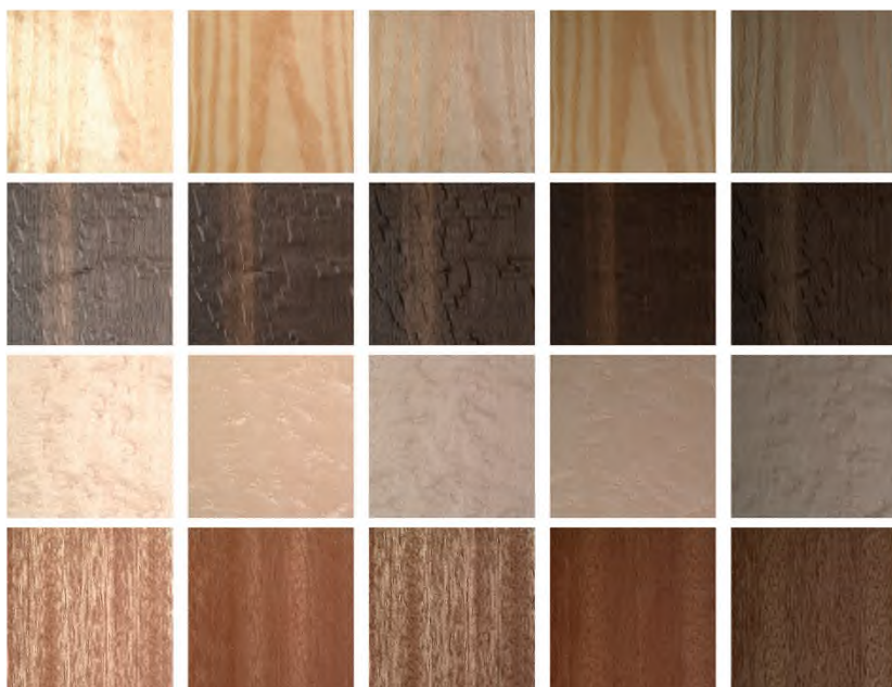
Obr. 7: Příklad vzhledu čtyř dřív z databáze Wood UTIA BTF při změnách směru osvětlení. Levý sloupec je osvětlen ve směru normály a směrem doprava roste elevační úhel 0, 30, 60, 60, 75 stupňů a azimut 0, 90, 180, 252, 345 stupňů.
