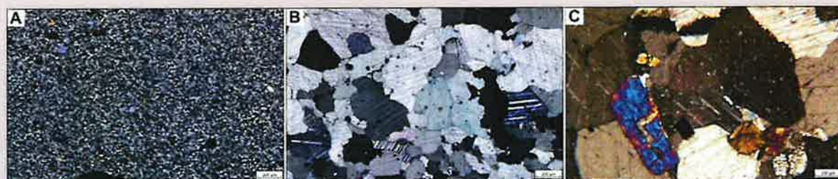
Mikrofotografie vybraných mramorů pozorované v polarizovaném procházejícím světle. A) Příklad velmi jemnozrnné struktury mramoru z lokality Ujčov. B) Hrubozrnná heteroblastická struktura, kamenický prvek z kláštera ve Žďáře nad Sázavou. C) Kalcitové krystaly se zrny diopsidu.
