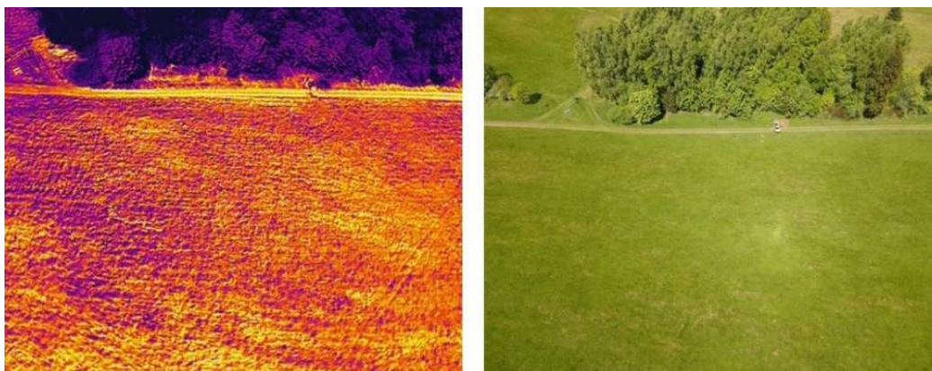
Obr. 5 Projev drenážní stavby na termokameře (foto: P. Fučík)
