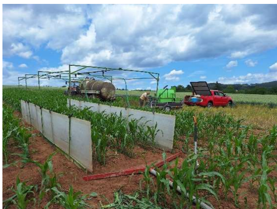
Obr. 9 Ověřování půdoochranných technologií pomocí polního simulátoru deště
