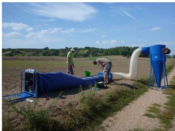
Obr. 7 Měření reálné ztráty půdy větrnou erozí
