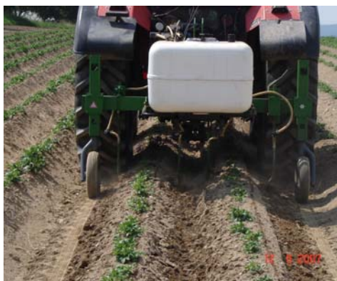
Funkční model podle návrhu VÚZT, v.v.i. při lokálním přihnojení aplikací kapalných minerálních hnojiv (KPH) během rané vegetace brambor
