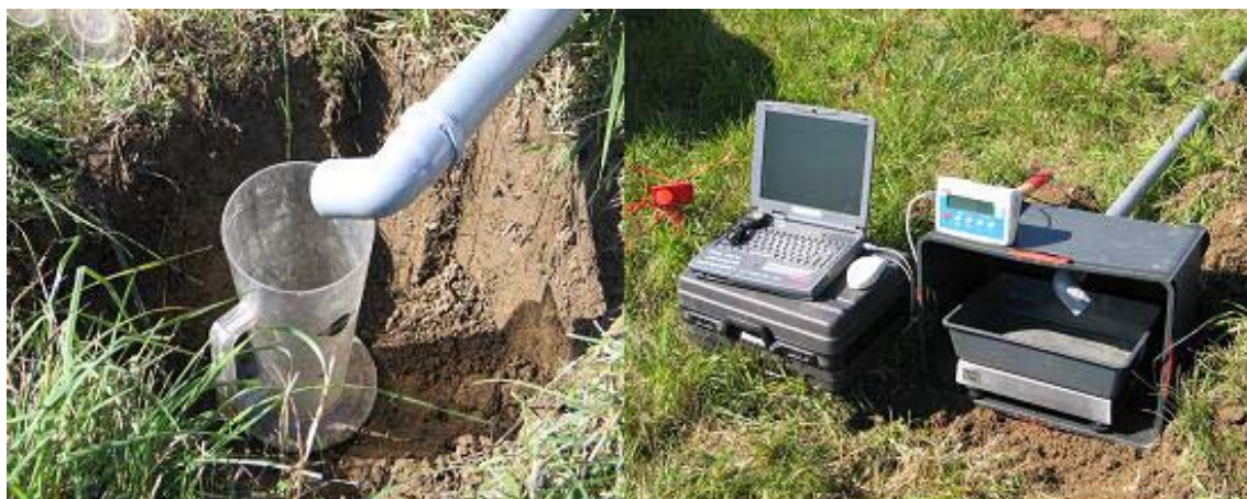
Ruční odečet objemu povrchového odtoku vody pomocí odměrných nádob (vlevo) a zařízení pro průběžné měření a vyhodnocení odtoku – digitální váhy Radwag WLC6 a PC (vpravo)
