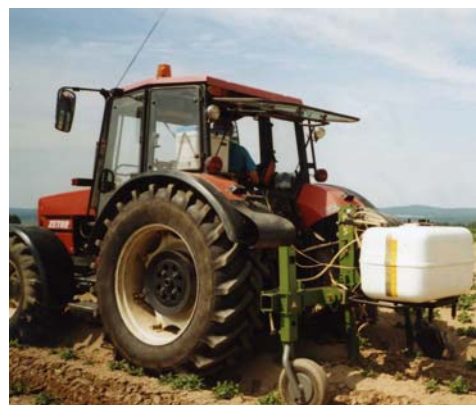
Funkční model podle návrhu VÚZT, v.v.i. při lokálním přihnojení aplikací kapalných minerálních hnojiv (KPH) během rané vegetace brambor
