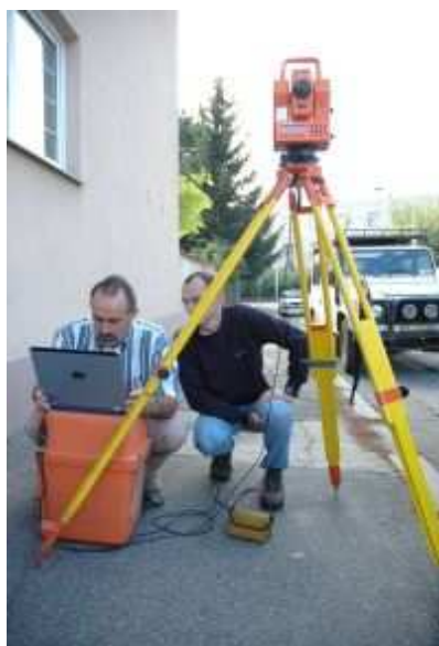
Obr.1: Zpracování dat z měření totální stanice
