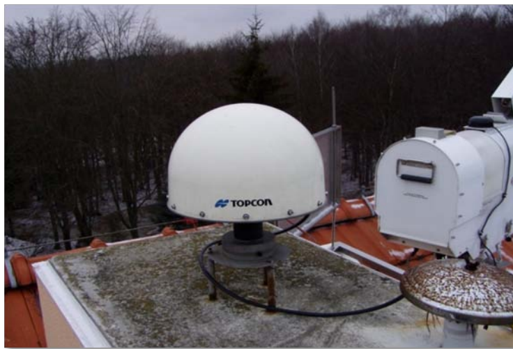
GNSS přijímač Topcon NetG3 s anténou Topcon CR-G3 na stanici GO Pecný
