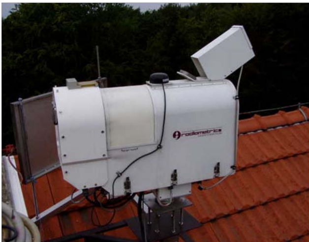
Radiometr vodních par TP/VWP (vlevo), instalace seismometru Guralp (vpravo)
