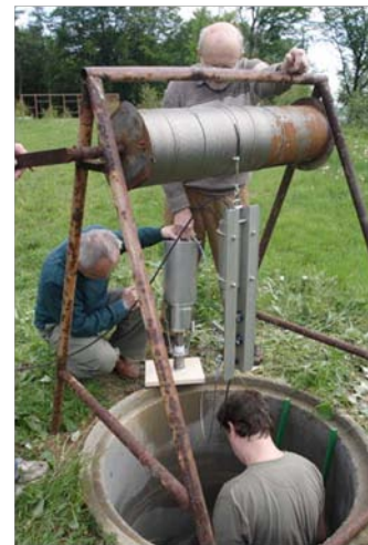
Radiometr vodních par TP/VWP (vlevo), instalace seismometru Guralp (vpravo)
