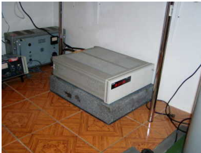
Stožár mobilní klimatologické stanice PŘF UK (vlevo), cesiové atomové hodiny (vpravo).
