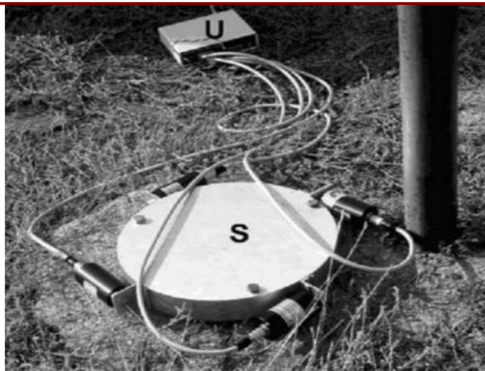
Obr. 5: Nový přenosný typ rotačního seismometru Rotaphone.
