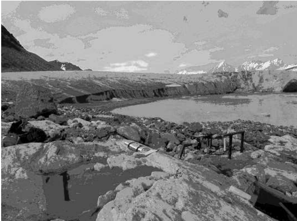
Obr. 9: Monitoring posunů na zlomu pomocí prostorového dilatometru TM71 v předpolí ledovce Hansbreen, Spitzbergen, Svalbard (viz kovová zařízení).
