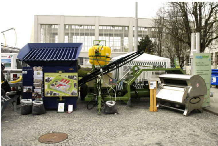
Technologická linka výroby plastického steliva pro skot
