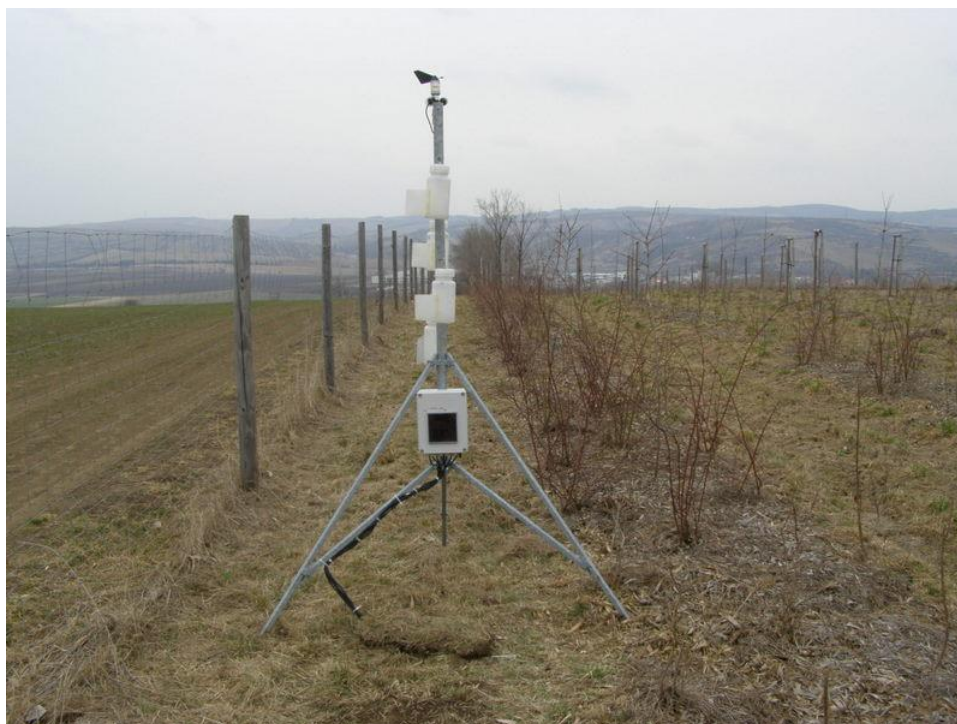
Obr. Prototyp deflametru a jeho umístění v k.ú. Hustopeče
