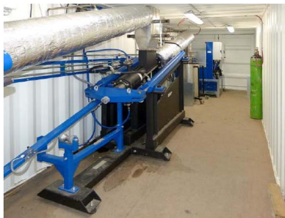
Obr. 9: Pohled na část zplyňovacího reaktoru s výsypkou technologické zkušební linky 20 \text{ kg}\cdot\text{h}^{-1} vstupního materiálu
