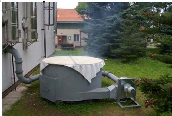
Obr. 6: Vývod kouřového potrubí k filtru
