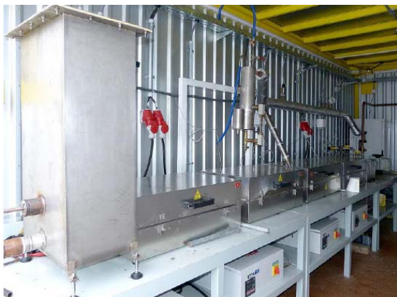
Obr. 8: Pohled na kontejnerovou vývojovou zkušební linku VÚZT, v.v.i. Praha - PolyComp, a.s. Poděbrady s výkonností 2 \text{ kg}\cdot\text{h}^{-1} vstupního materiálu
