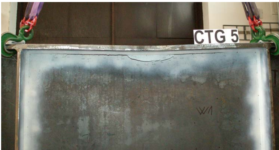
Zhroutení stěny vlivem opakovaného namáhání místním tlakem
