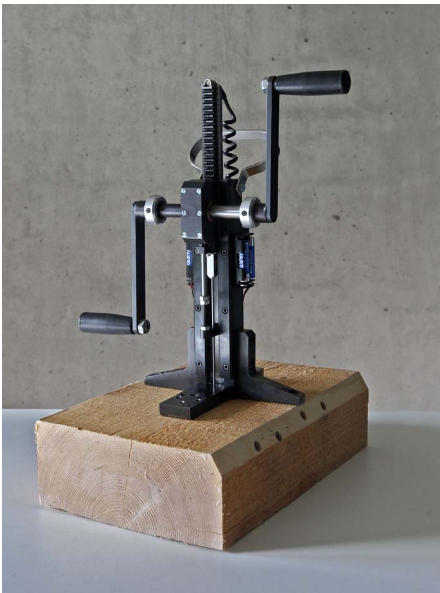
Zařízení pro měření mechanického odporu dřeva proti vnikání trnu nebo při vytahování vrutu
