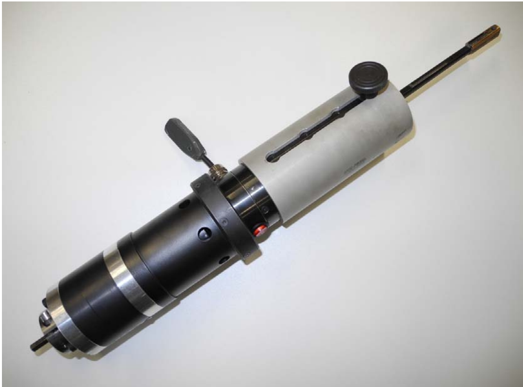
Zařízení pro měření pevnosti a modulu přetvárnosti při roztlačování čelistí ve vyvrtaném otvoru
