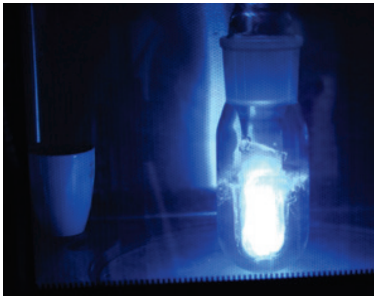
Experimentální uspořádání pro mikrovlnné fotochemické experimenty s bezelektrodovými výbojkami (EDLs)
