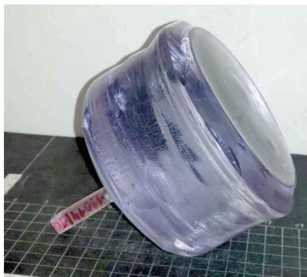
■ Obr. 2 Neopracovaný Yb:YAG krystal o průměru 10 cm s úrovní dopování Yb 2 %, vypěstovaný novou metodou vyvinutou ve spolupráci FZÚ a CRYTUR, spol. s r. o.
