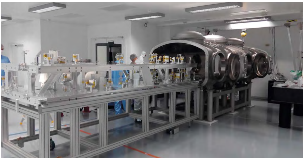
■ Obr. 6 Kompresor čerpacích laserů pro výkonovou část systému L1, zkompletovaný v roce 2015. Snímek ukazuje vysunutý optomechanický interiér kompresoru při testování v prostorách centra HiLASE, kde je kompresor dočasně umístěn.
