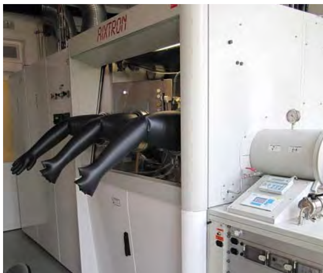
■ LABONIT – Nová MOVPE aparatura fy Aixtron pro růst GaN struktur.
