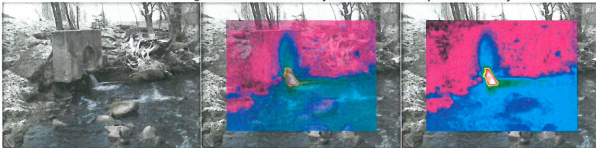
Obr. č. 10: Termografické snímkování výusti ČOV Jince - povodí Litavky
