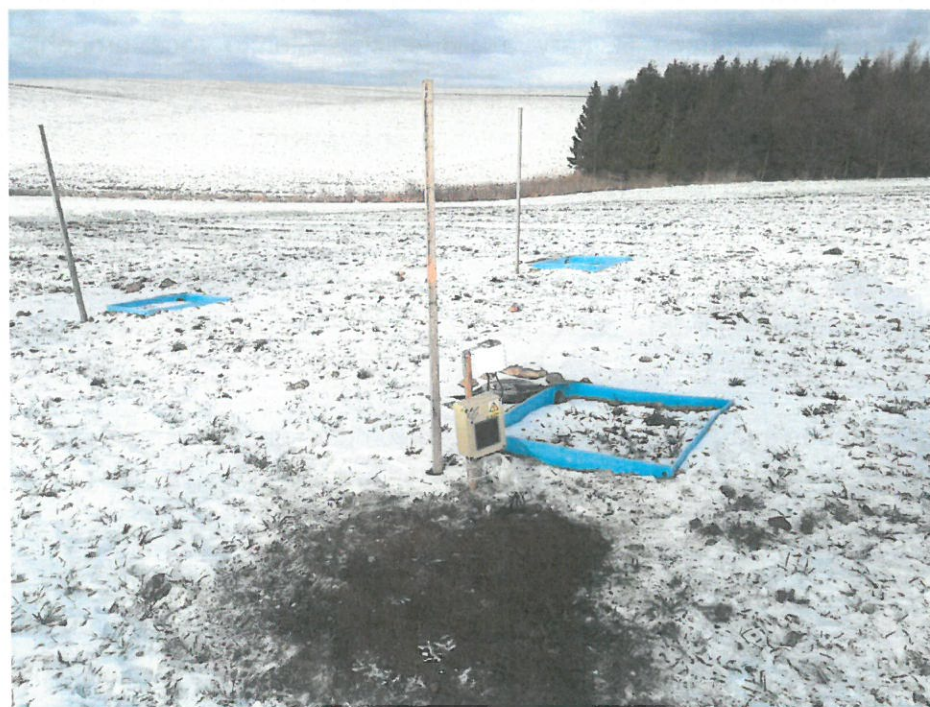
Obr. č. 14: Experimentální plocha pro monitoring intenzity eroze z tání sněhu (k.ú. Větrňkovice)
