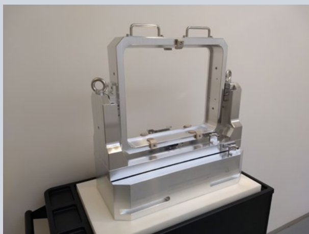
Obr. 169 Vlevo: Montáže zrcadel L3 (tzv. L-mounty), vpravo: Montáž dichroického zrcadla pro L4n Beam Transport.
