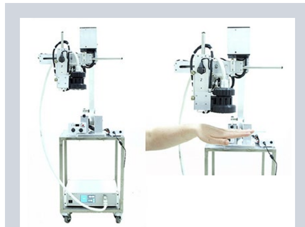
Obr. 79 Aplikátor pro automatické skenování větších ploch, který umožňuje aplikovat určitou dávku plazmatu rovnoměrně po velké ploše skenovacím způsobem.
