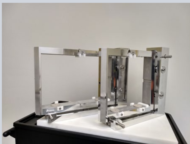
Obr. 169 Vlevo: Montáže zrcadel L3 (tzv. L-mounty), vpravo: Montáž dichroického zrcadla pro L4n Beam Transport.
