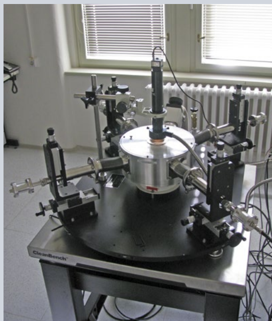
Obr. 35: Měřicí stanice Probe Station Janis Research ST-500 pro transportní měření v definované atmosféře, zakoupená za investiční podpory AV ČR.
