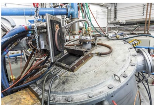
Obr. 55: Aparatura Golem pro plazmové zplyňování odpadu vyvíjené ve spolupráci s Ústavem fyziky plazmatu a firmou HVM Plasma, s.r.o., včetně možných zpracovávaných odpadů RDF (refuse derived fuel), tj. zbytkového směsného odpadu po vícestupňovém procesu třídění nebo nebezpečného bioodpadu.
