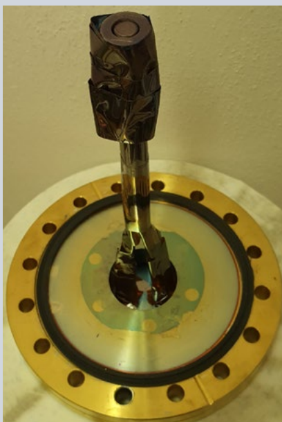
Obr. 87 Fotografie RF iontové planární sondy po vyjmutí z plazmatu
