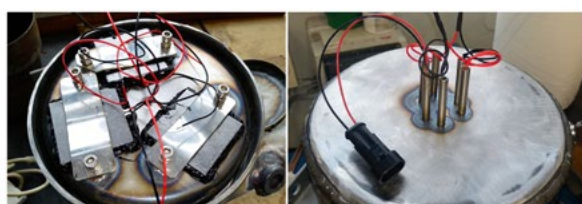
Obr. 48: Nákrasy dvou navržených možností a reálné umístění termoelektrických modulů v nezávislém topení.
