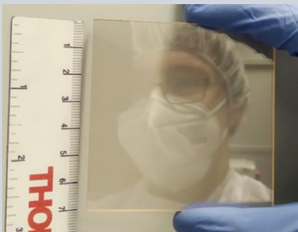
Obr. 115 TGG krystal s rozměrem 69×69 mm 2 .
