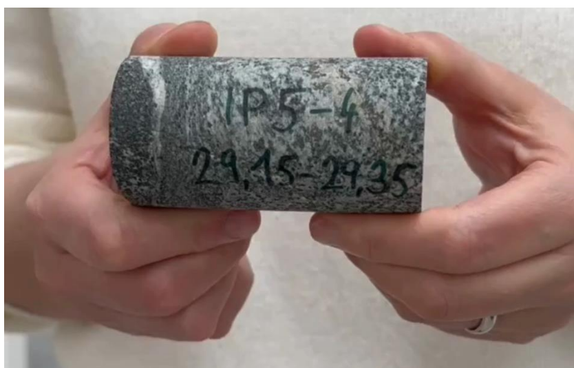
Ilustrační foto: Vzorek pro testování skalního podloží jaderné elektrárny Dukovany II.
