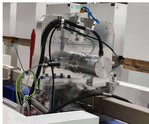
Část neutronovodu systému BEER se zařízením pro výběr vlnové délky (příspěvek společnosti Hereon) instalovaným v roce 2025.
