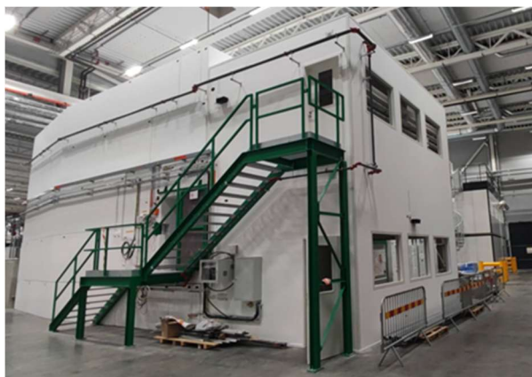
Stíněný experimentální prostor a kontrolní kabina zařízení BEER@ESS v Lundu (části dokončeny v prosinci 2025).
