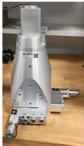
Neutronová štěrbina připravená k instalaci na difraktometru SPN-100.
