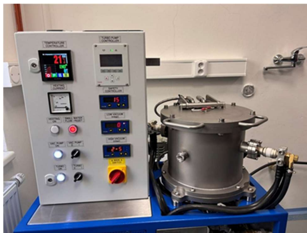
Vysokoteplotní vakuová pec pro syntézu a modifikaci hybridních kompozitů na bázi alotropů uhlíku (fullerénů) a feroik ve vakuu nebo v inertní atmosféře při vysokých teplotách (až 2000 °C).
