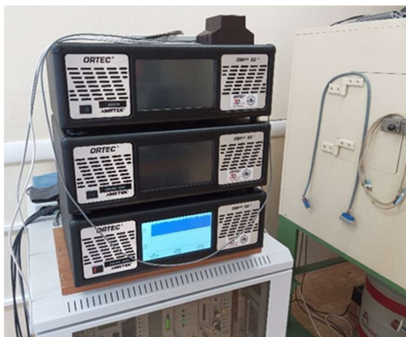
Tři z šesti digitálních mnohokanálových analyzátorů Ortec DSPEC 50, jejichž nákup byl realizován v rámci přístrojových investic AV ČR.
